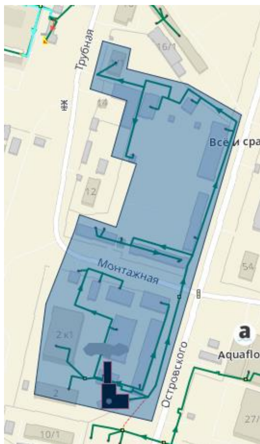
Рисунок 4.32 – Зона действия котельной №8 ПАО «Сургутнефтегаз»
